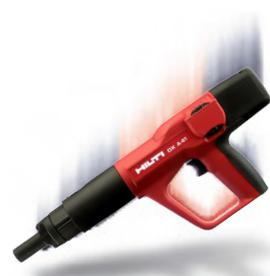
**El dispositivo de seguridad contra las caídas.** Es el resultado de acoplar el mecanismo de encendido con la presión de contacto. De esta forma se evita el encendido accidental de la herramienta si ésta golpea contra una superficie dura, independiente del ángulo con que impacte.
