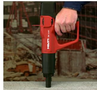
**El dispositivo de seguridad de presión de contacto** hace necesario aplicar a la herramienta una fuerza determinada contra la superficie de trabajo. Sólo es posible el encendido apretando completamente la herramienta contra el material base.
